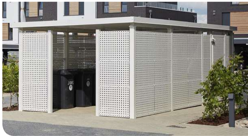
Abb. 31.3 Beispiel Einhausung mit Blechverkleidung
